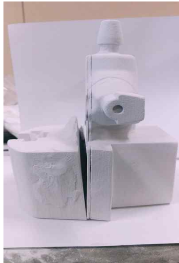
<그림> 노즐 막힘 현상에 의한 프린팅 결과물 (크랙 및 퀄리티 저하)
