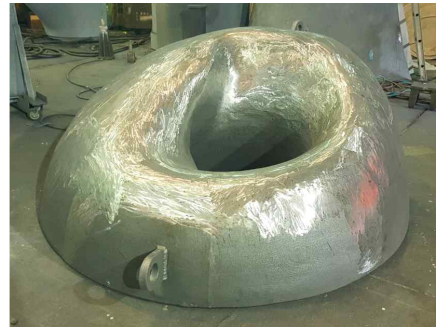
<그림> (주)에스에프에스에서 실증화에 성공한 선박용 벨마우스 출력물 및 제품 사진
