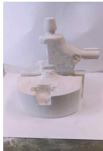
<그림> 노즐 막힘 현상에 의한 프린팅 결과물 (크랙 및 퀄리티 저하)
