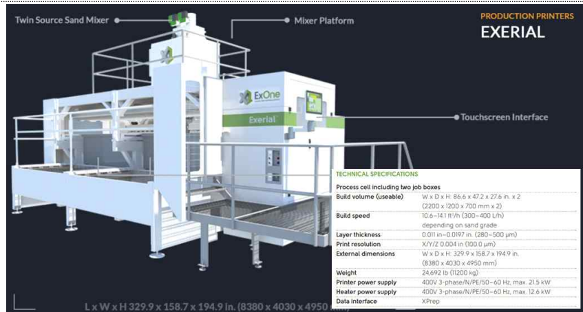
<그림> ExOne의 대표 장비 사진 및 사양
