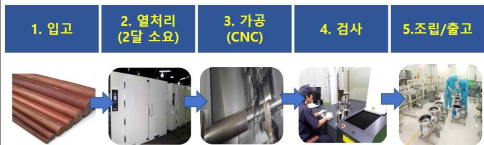
그림3. 기존 변위기(재생기, Displacer) 생산공정도
