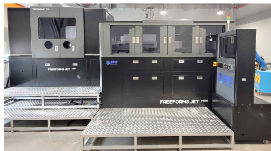
<그림> (주)에스에프에스의 1m급 바인더 젯 장비
